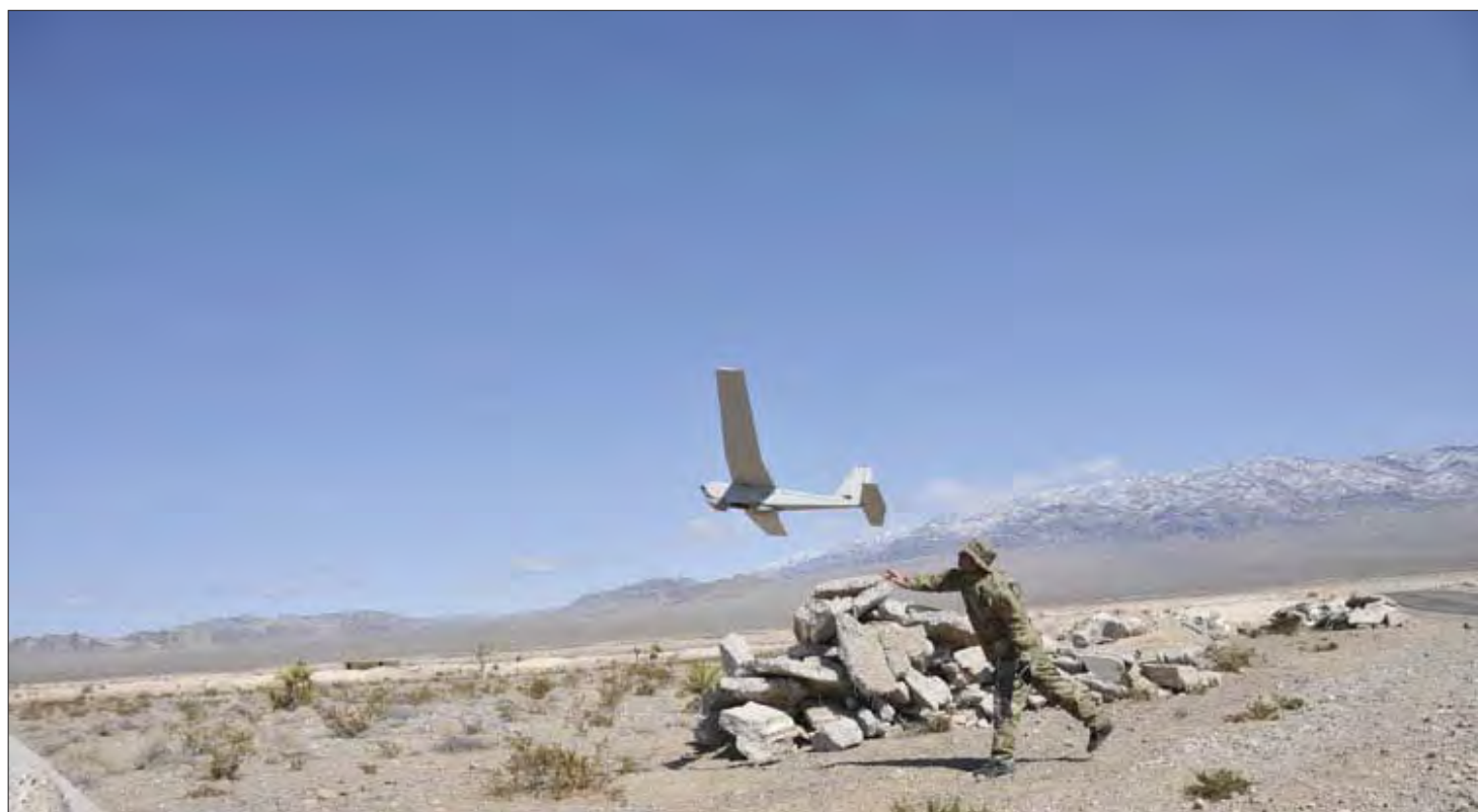
图7. AeroVironment 公司的美洲豹 AE 小型无人驾驶飞机的推出, 使用 Alta 太阳能动力已经实现了 9 小时的飞行。
