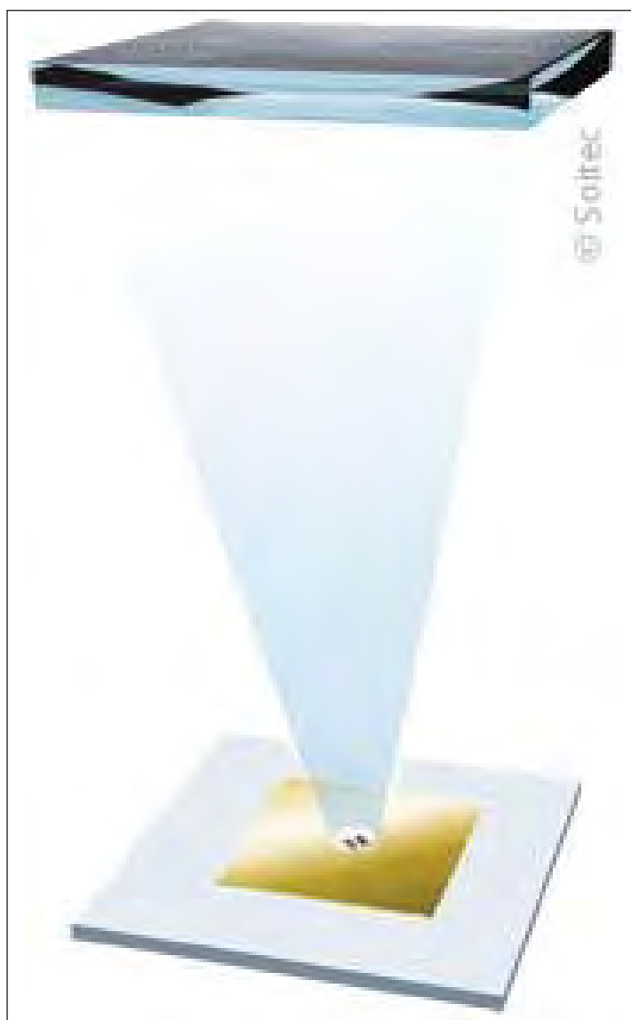
图3. Soitec的聚光光伏模块的示意图。
